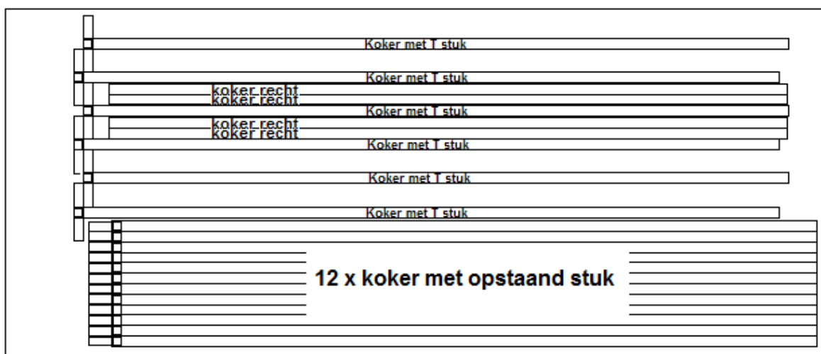
IJzerwerk achterwand op het kokerprofiel leggen.
